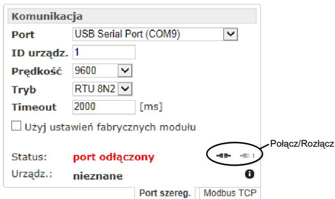
Rys. 9. Nawiązywanie połączenia z miernikiem N21
