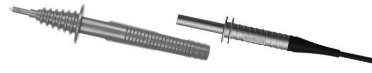
Rys. 39 Sonda dotykowa powinna być używana z sondą ostrzową lub krokodylem.
