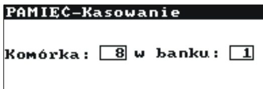
Rys.29 Kasowanie komórki pamięci: 1 – nr banku, 8 – nr komórki, 1 – bank z co najmniej jedną zajęta komórką, 8 – komórka zajęta
