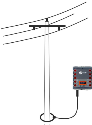
Rys.9. Praca przyrządu przy użyciu pojedynczych cęgów
