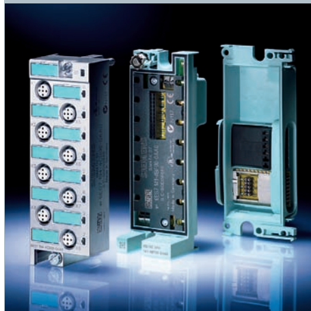
Trzy części modułu rozszerzającego złącze, elektronika oraz magistrala
