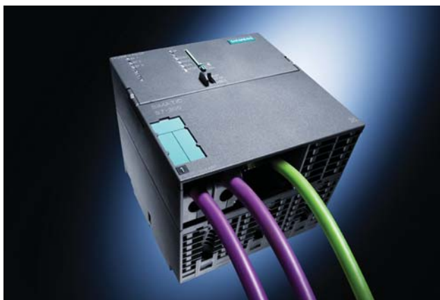
Super szybki CPU 319-3 PN/DP z interfejsem PROFINET
